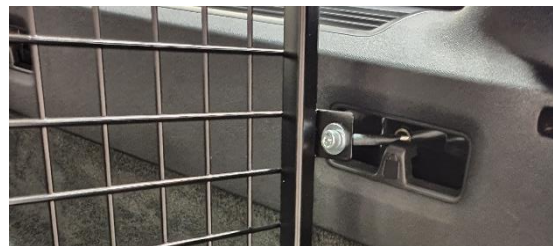
Figur 1. Användning av befintliga fästpunkter
