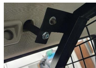
Figur 7. Användning av befintlig fästpunkt i taket
