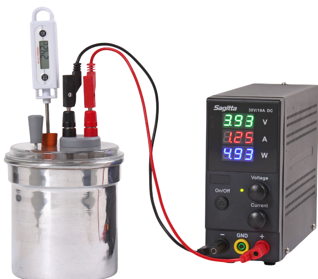
Fördelen med att använda ett Spänningsaggregat DC Elektronisk Effekt är att vi kan läsa av effekten under hela försöket
