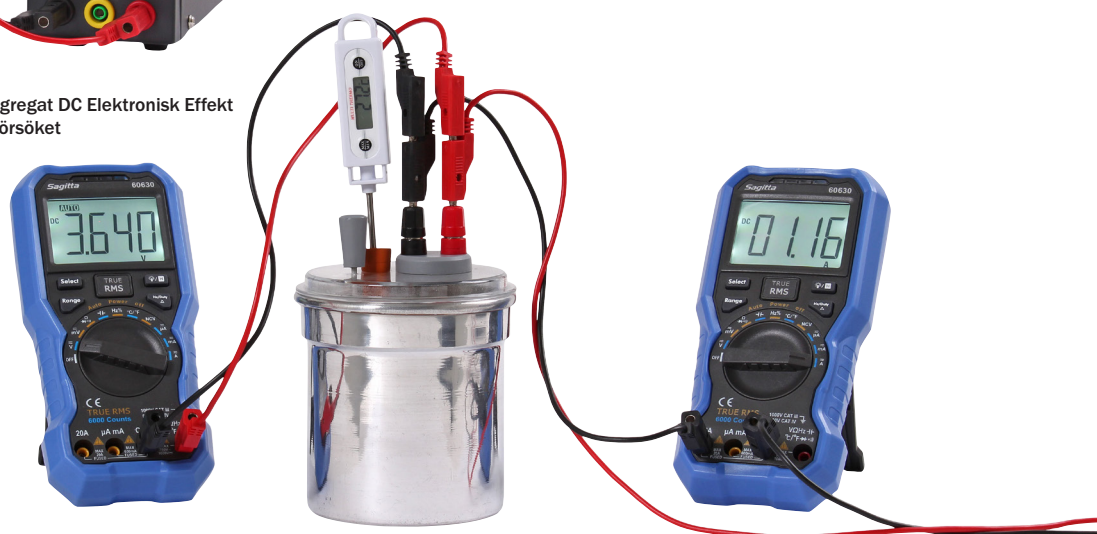
Om vi inte har tillgång till ett Spänningsaggregat DC Elektronisk Effekt använder vi oss istället av två multimetrar för att räkna ut effekten.
